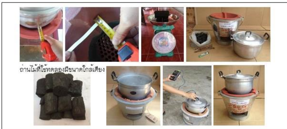
ภาพที่ ๓ การวัดคุณสมบัติและทดสอบประสิทธิภาพการใช้งานตัวอย่างเตาจากผู้ประกอบการ
